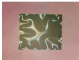
Membrana realizata pe plachete de siliciu
